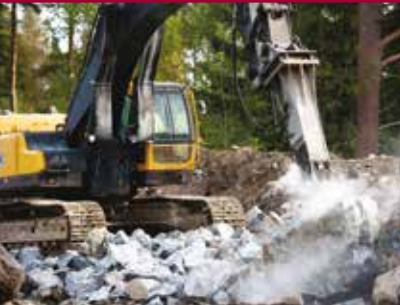
Hidraulični čekić Hardox® 400/450 u kućištu hidrauličnog čekića koje je izloženo trošenju uslijed stijena.
