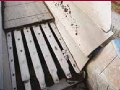
Klizna staza U kliznoj stazi koja vodi u drobilicu, Hardox® 500/550/600 je očit izbor u teškom okruženju.
