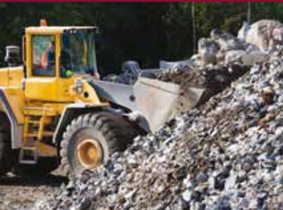
Kašika Hardox® 450/500/550 u cijeloj kašiki ili u reznom bridu i na stranama, zavisno od stanja u pogledu trošenja.
