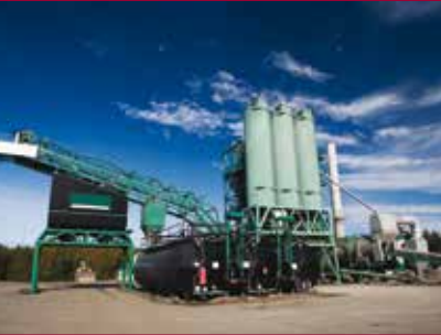
Asfaltna baza Hardox® 450/500/550 kao obloge i u kliznim stazama za šljunak. Hardox® 450/500 u krilcima bubnja. Hardox® 450/500 u transportnom spremniku od bubnja do dopremnog vratila kamiona.
