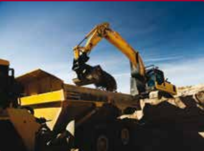
Kašika bagera Hardox® 450/500/550 u kašiki bagera. Hardox® se može upotrebljavati u cijeloj kašiki ili samo u reznom bridu i na stranama, zavisno od stanja u pogledu trošenja.
