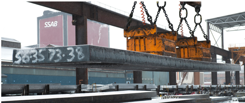
Figur 5. Stålämnen (slabs) från Luleå och Oxelösund är utgångsmaterialet för tillverkning av tunnplåt i Borlänge. Fotograf: Pär K Olsson
