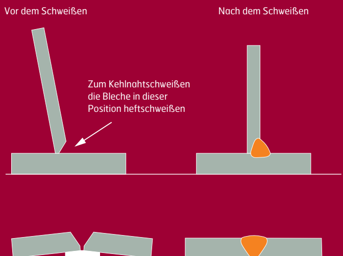
Abb. 11: Voreinstellung einer Kehlnaht und Einzel-Y-Naht.
