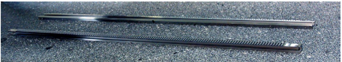
Figura 2. Cremallera con mecanizado de precisión de Toolox® 33
