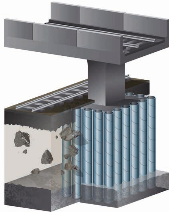
Kuva 7. RD-paaluseinä törmäyskuormitetun sillan välituessa
