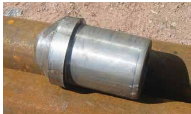
Kuva 12. Esimerkki hydraulivasaran terän ja paalun välistä lyönninaikaisesta sovitinkappaleesta.
