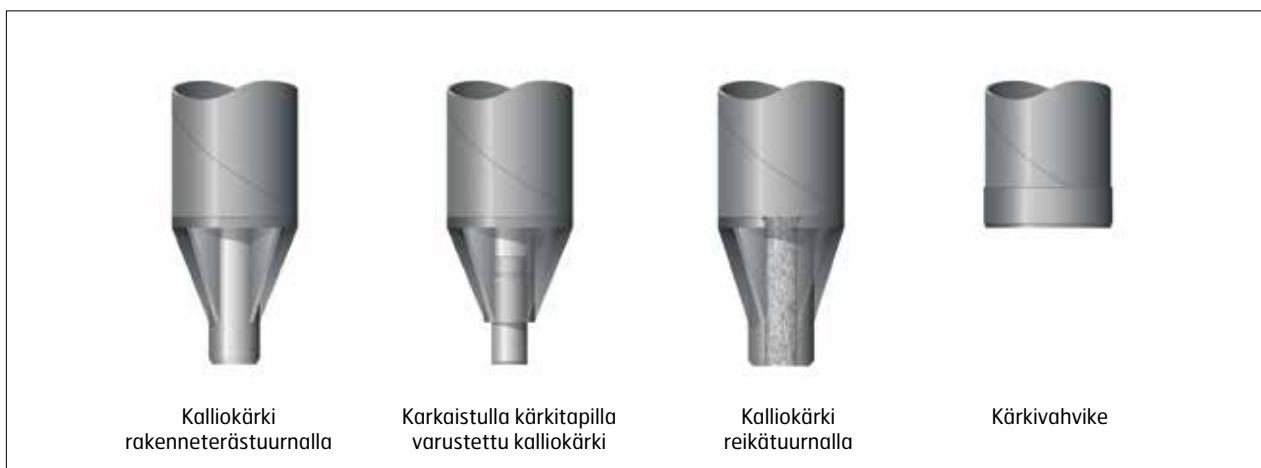
Kuva 3. Suuriläpimittaisten RR-paalujen paalukärkityypit.
