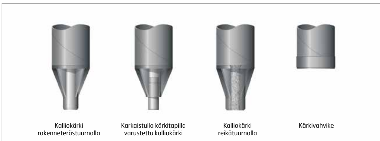
Kuva 3. Suuriläpimittaisten RR-paalujen paalukärkityypit.
