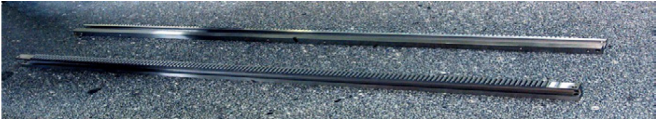
Fig 2. Toolox 33 Cremagliera lavorata di precisione
