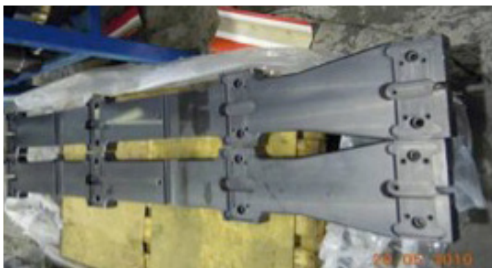
Fig 1. Travi di sostegno Toolox® 33
