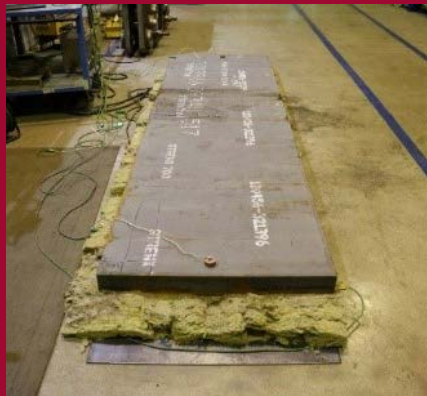
5. 강판을 올려 놓은 후 시간이 지남에 따라 온도를 기록할 열전대를 설치합니다
