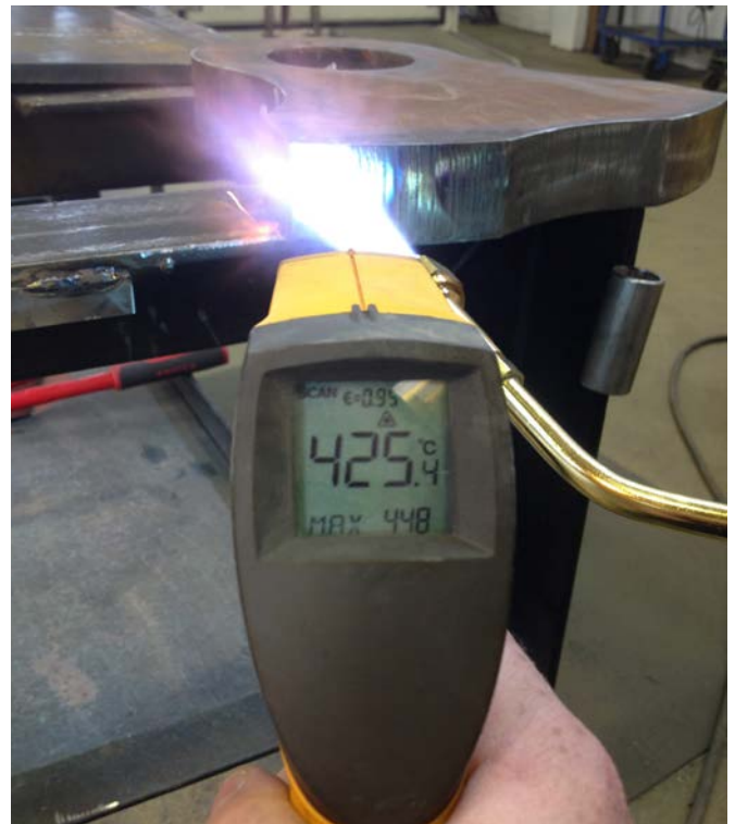
그림 10: 후열 처리 도중 온도 측정.
