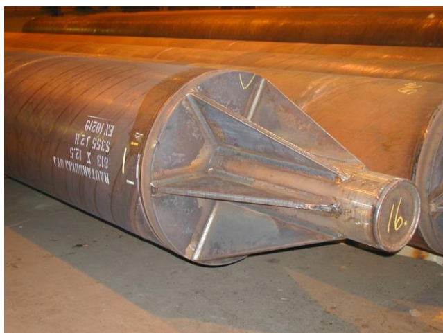
Rys.1a. But skalny ze stali konstrukcyjnej.
