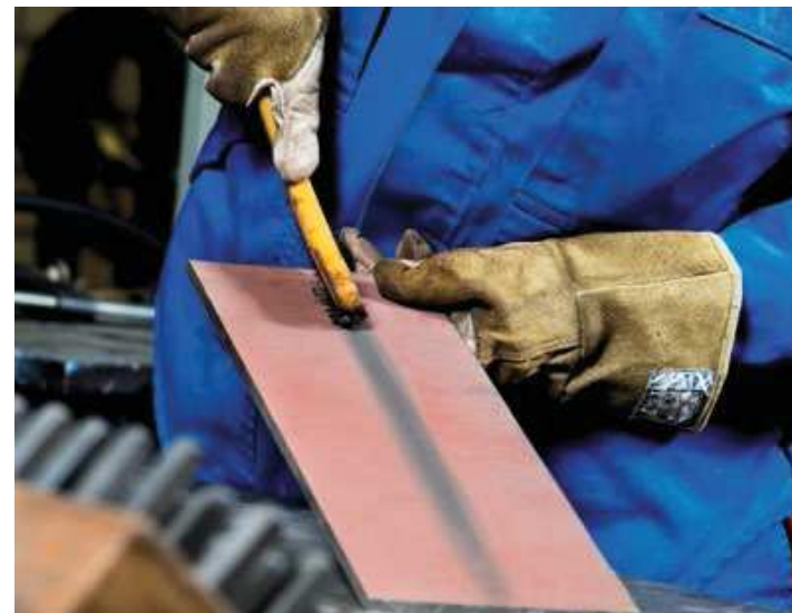
Figura 13: Caso necessário, é fácil remover o primer com escova
