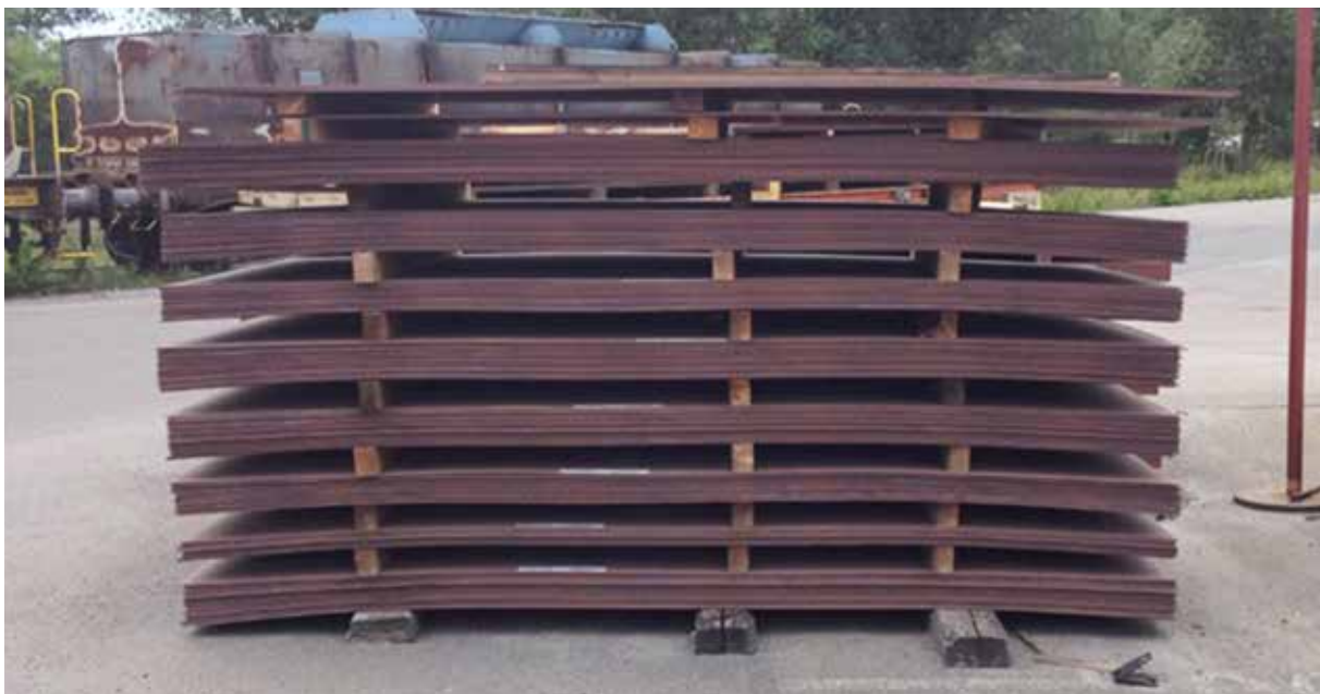
FIGURA 11. Chapas empilhadas adequadamente.
