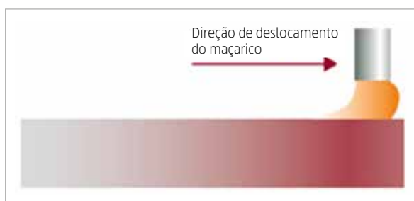
FIGURA 6. Cor da borda de corte atrás do maçarico de pós-aquecimento.
