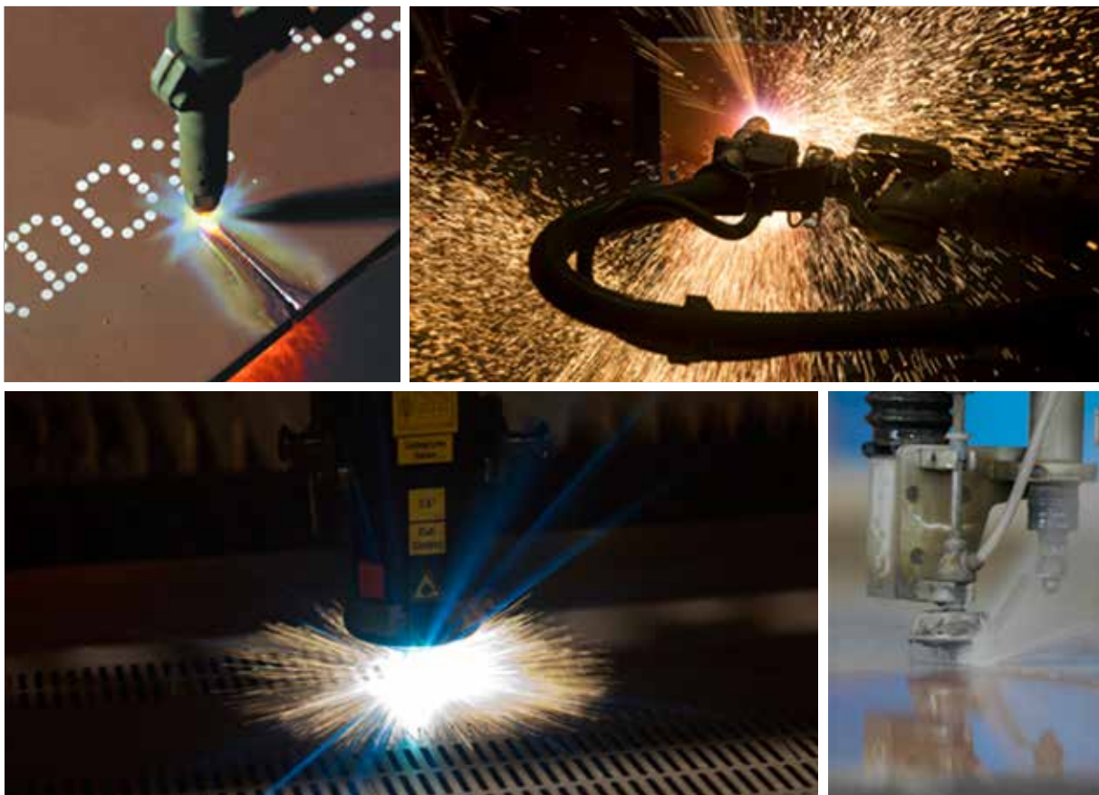
FIGURA 1. A partir do canto superior esquerdo, corte oxicom bustível, corte plasma, corte laser e corte a AWJ.
