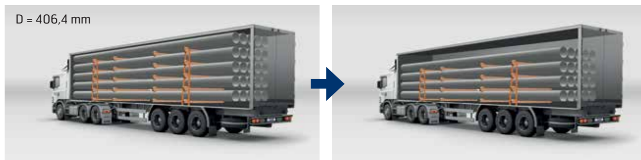
Figur 2. För att säkra lasten vid lossning av rör D \geq 406,4 mm ska lyftstropparna fästas på översta mellanläggsnivån på båda sidor av lasten. Se även Tabell 2.
