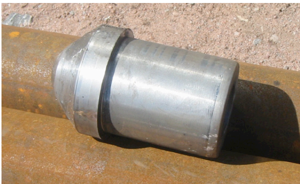
Figur 5.1. Exempel på lastfördelande slagdon mellan hammaren och pålen.
