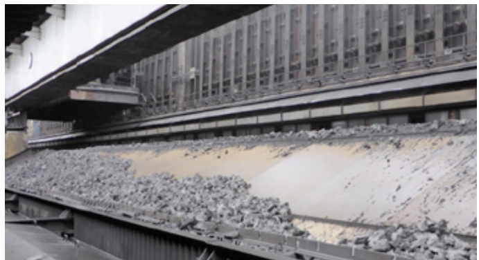
Fig 4. Svalbädd tillverkad av Toolox® 33
