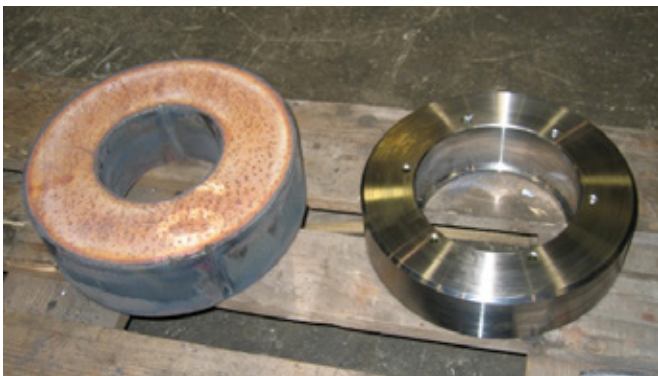
Fig 3. Toolox® 44 styrhjul till travers
