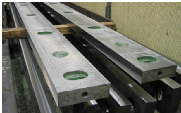
Fig 2. Saxskär av Toolox® 44
