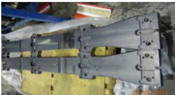
Fig 1. Stödbalkar av Toolox® 33
