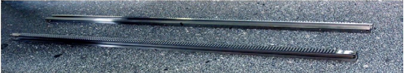
Şekil 2. Hassas işlenmiş Toolox® 33 dişli yolu
